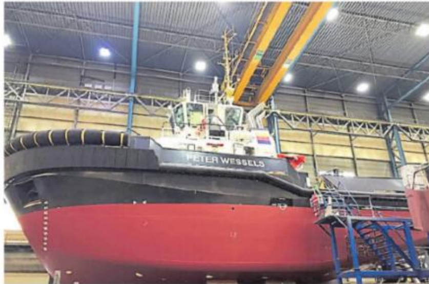
5400 PS, 63 Tonnen Pfahlzug: die „Peter Wessels“ in einer Halle der niederländischen Damen Werft.
